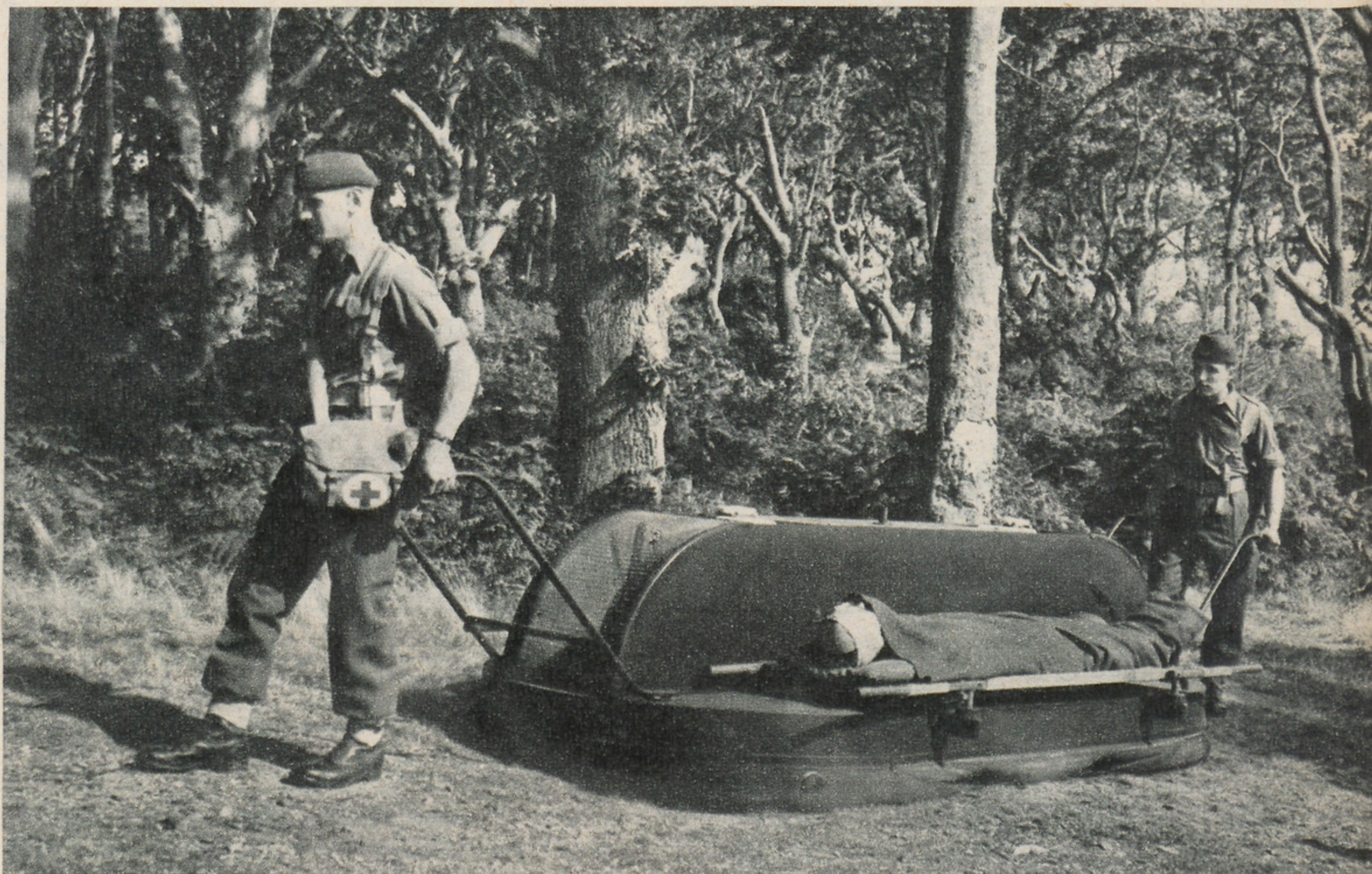
Plus la moindre secousse n'est à craindre avec la civière à effet de sol construite par Folland.
