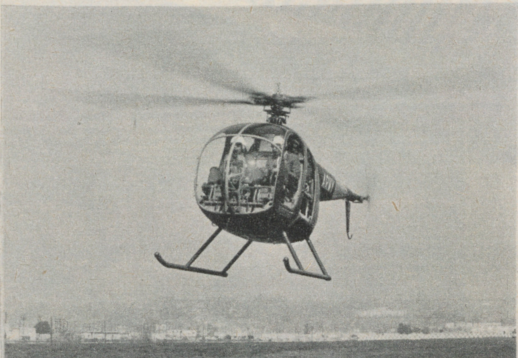
Pour le programme LOH de l'Armée de Terre U.S., Hughes vient de faire voler son type OH6-A, muni d'une turbine à gaz Allison T63 développant 250 ch.
