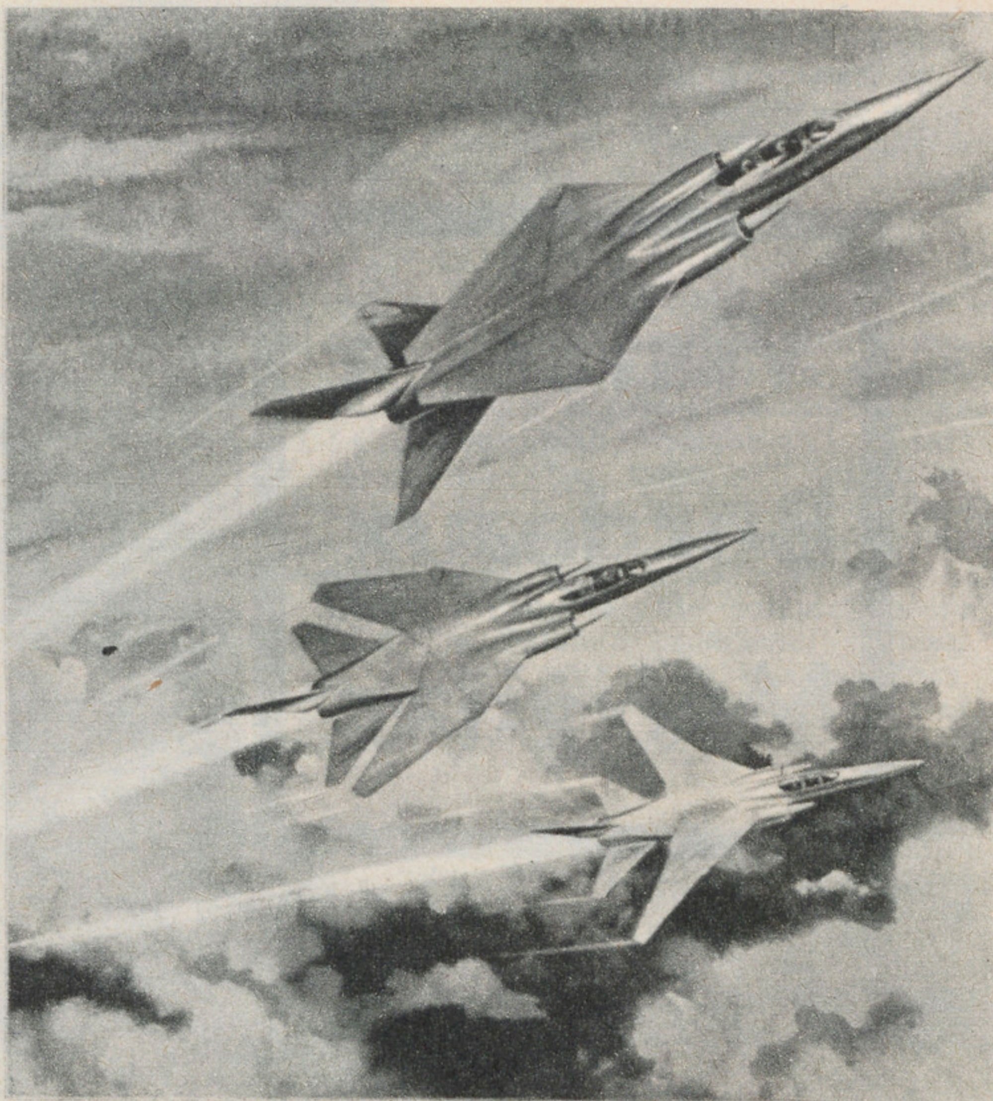
Le rapport d'United Aircraft nous montre, dans cette composition, les configurations du projet TFX à géométrie variable développé par General Dynamics (Convair) et Grumman, et propulsé par deux réacteurs à turbofan Pratt and Whitney JTF-10A-20. Une version de ce moteur est destinée au GAMD « Mirage » IIIV (SNECMA - PW TF-106) et doit voler d'abord sur le « Mirage » IIIT.
