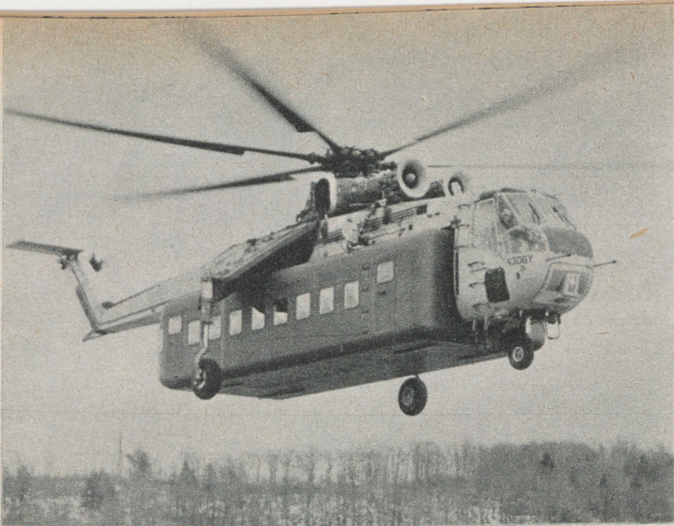
Le Sikorsky S-64 « Skycrane » vient de voler avec un container capable de recevoir 68 soldats, ou 55 blessés couchés, ou 55 passagers sur sièges commerciaux.
