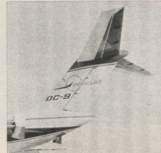
A gauche, la pointe avant recèle l'antenne oscillante du radar météorologique. A droite, l'arrière de l'avion, avec les inverseurs de poussée braqués et l'élégant empennage en T avec son bulbe de raccordement.
