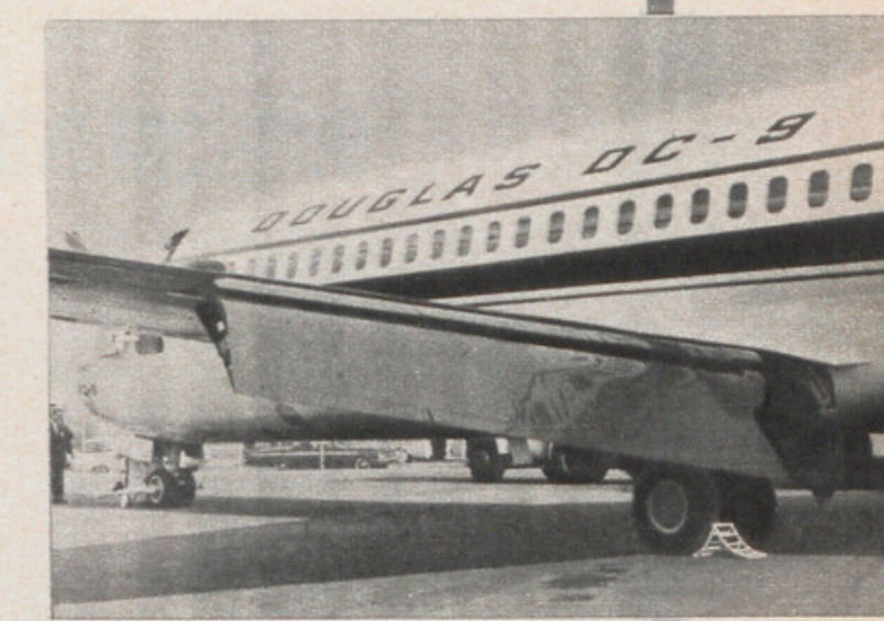
Le Douglas DC-9, dont on voit le plan trois vues ci-contre est équipé d'une voilure à flèche modérée dont les volets hypersustentateurs, ci-dessus, sont à double fente. Remarquer la disposition serrée des hublots.
