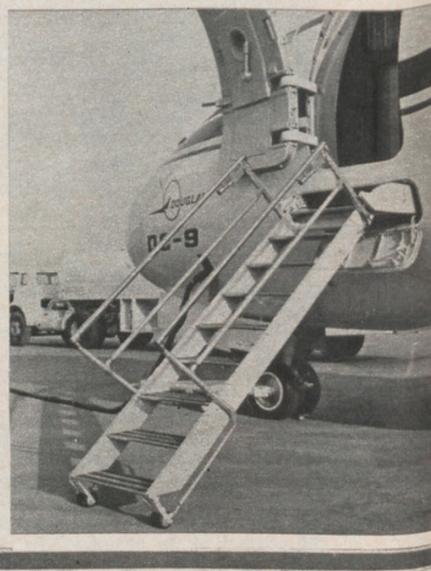
Ci-dessus et ci-dessous, les deux séquences essentielles de la sortie de l'escalier intégré, normalement escamoté sous la porte d'accès.
