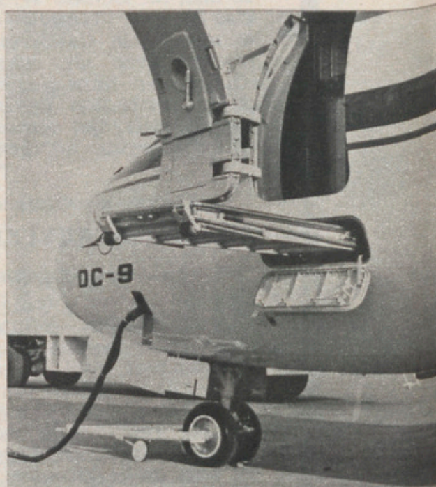
Ci-dessus et ci-dessous, les deux séquences essentielles de la sortie de l'escalier intégré, normalement escamoté sous la porte d'accès.
