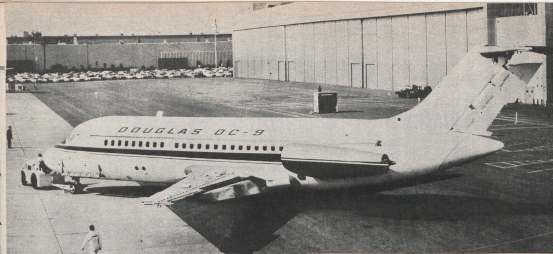
Le Douglas DC-9, dont on voit le plan trois vues ci-contre est équipé d'une voilure à flèche modérée dont les volets hypersustentateurs, ci-dessus, sont à double fente. Remarquer la disposition serrée des hublots.
