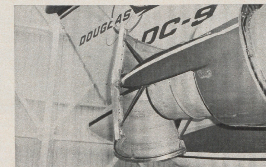
Les inverseurs de poussée consistent en deux demi-coquilles en acier inoxydable venant intercepter le flux à la sortie de la tuyère et qui sont normalement effacés dans le prolongement des nacelles-réacteurs...
